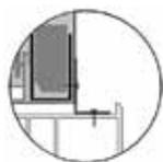
La liaison entre le coffre et la menuiserie sera assurée par les pattes fixées sur le U acier et la menuiserie. Les pattes sont fournies.
