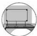
Une réservation dans le Pse assure la liaison entre le renfort et le béton. Le maçon devra liaisonner le renfort au chaînage avant coulage du béton.
